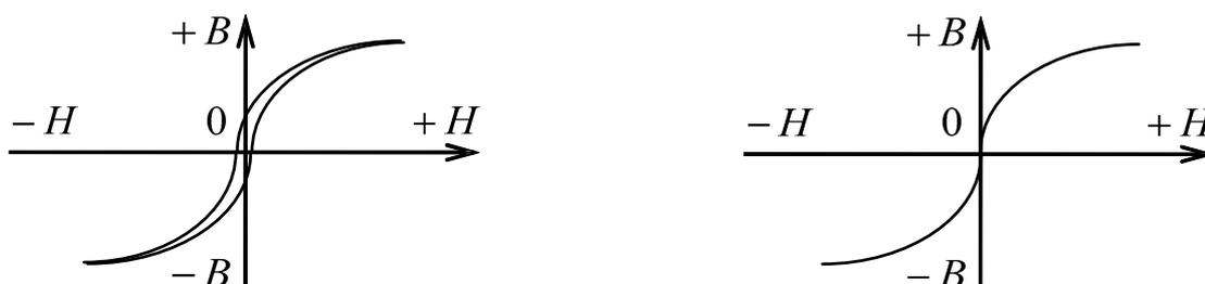
*Рисунок 3 - Петля гистерезиса и кривая намагничивания стали*
